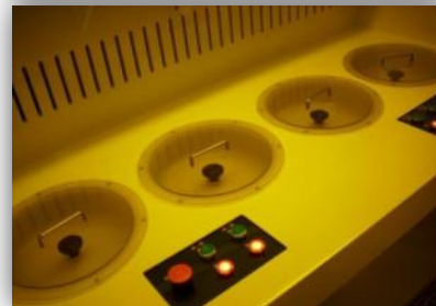
2吋基板光阻塗佈用 For 2in wafer PR coating
