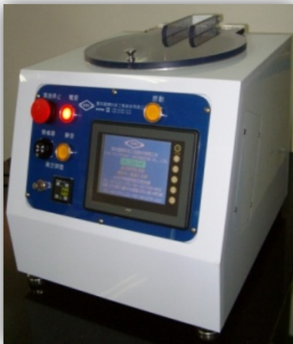
2-6吋輕便型旋轉塗佈機 2-6in portable spin coater
