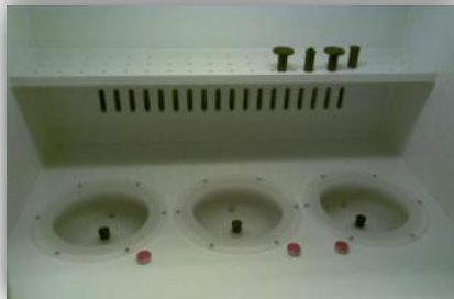
2吋基板光阻塗佈用 For 2in wafer PR coating
